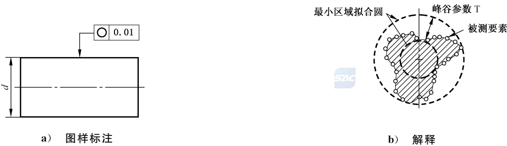
图 1 圆度图样标注及解释
