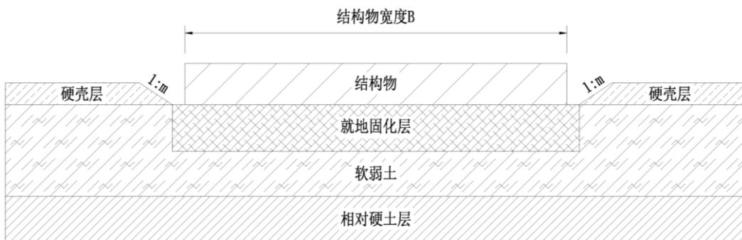
b) 结构物基础浅层固化处理
