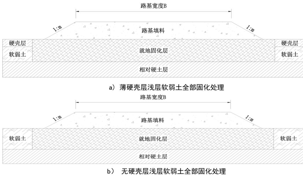
图3 浅层软弱土全部固化处理示意图
