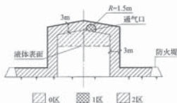
图 B.0.3 储存易燃液体的地上固定顶储罐爆炸危险区域划分
