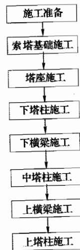
图 17.2.1 索塔施工流程图
