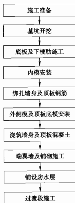
图 18.2.1 框架涵施工流程图
