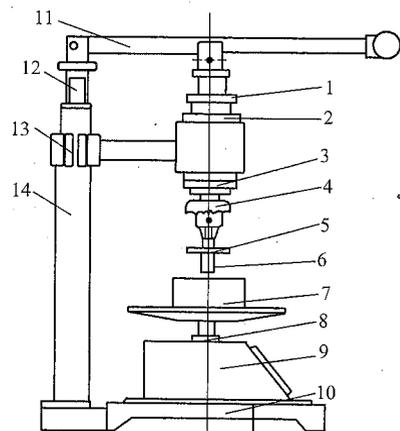
图 8.0.2 砂浆凝结时间测定仪
