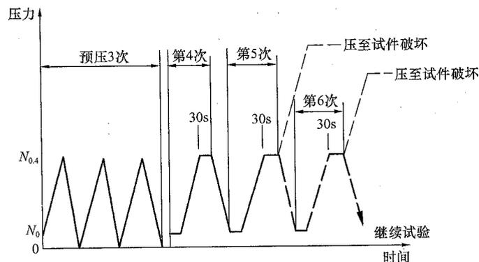
图 16.0.5 弹性模量试验加荷制度示意图
