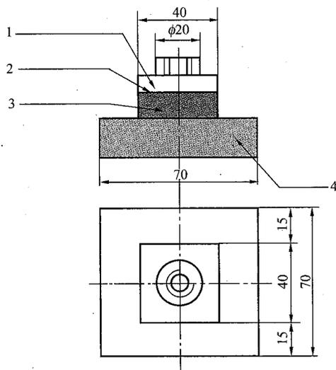
图 10.0.2-1 拉伸粘结强度用钢制上夹具
